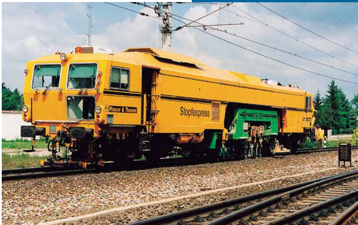
09 3X: Primera bateadora de trabajo continuo de tres traviesas de alto rendimiento.
