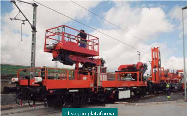
El vagón de tendido cuenta con un sistema de tensado para tres hilos.
