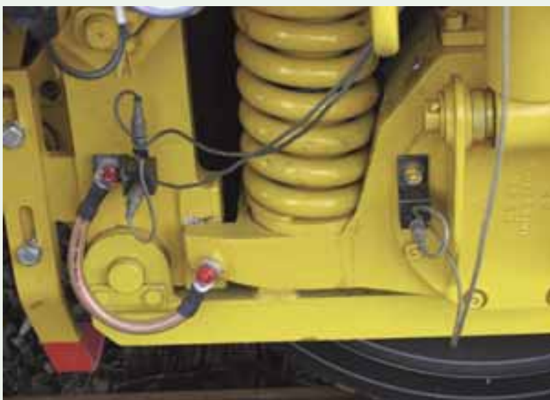
Figura 5: Acelerómetros colocados en dirección vertical y horizontal sobre un eje individual
