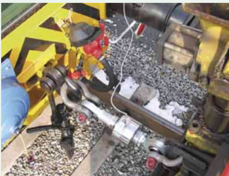
Figura 6: Transmisor de tracción para la medición de la fuerza de frenado del freno de estacionamiento
