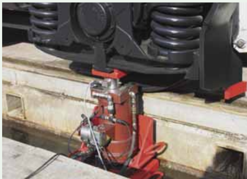
Figura 4: Banco de pruebas móvil de resistencia a torsión (en la imagen uno de los ocho cilindros hidráulicos de levante, controlados por servos).
